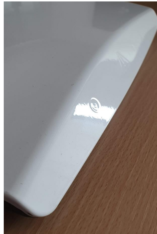
Dit product heeft een hoge glansgraad en geen textuur. In het strijklicht zijn oneffenheden te zien. De knop in het midden is trouwens bewust als graving in de matrijs aangebracht.
