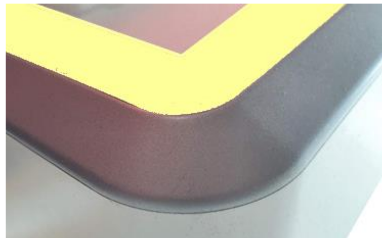
Bij dit witte product wordt de rand metaalkleurig gelakt. Om het kunststof goed te kunnen maskeren worden voorgestante sjablonen gebruikt.
