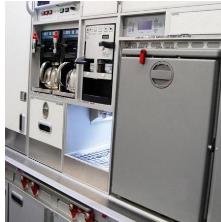
Stoomovendeur uit glasgevuld PES, volledig gelakt en voorzien van inserts.
