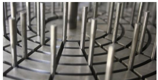
Detailansicht einer Form mit langen, dünnen Auswerfern.
