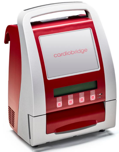
Behuizingsdelen van een controle-unit voor hartbewaking. Ondanks de lage jaarvolumes is gekozen voor spuitgieten en TSG, deels in combinatie met lakken.
