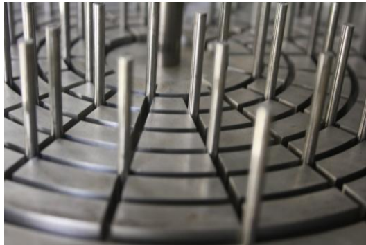
Detail van een matrijs met lange, dunne uitstoters.
