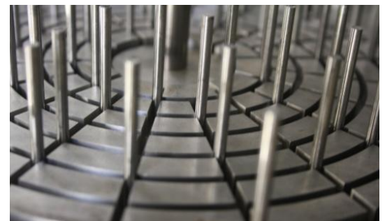
Detail van een matrijs met lange, dunne uitstoters.
